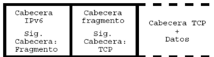
Figura 12. Cabecera IPv6 básica, fragmento y datos. Fuente: [49]
